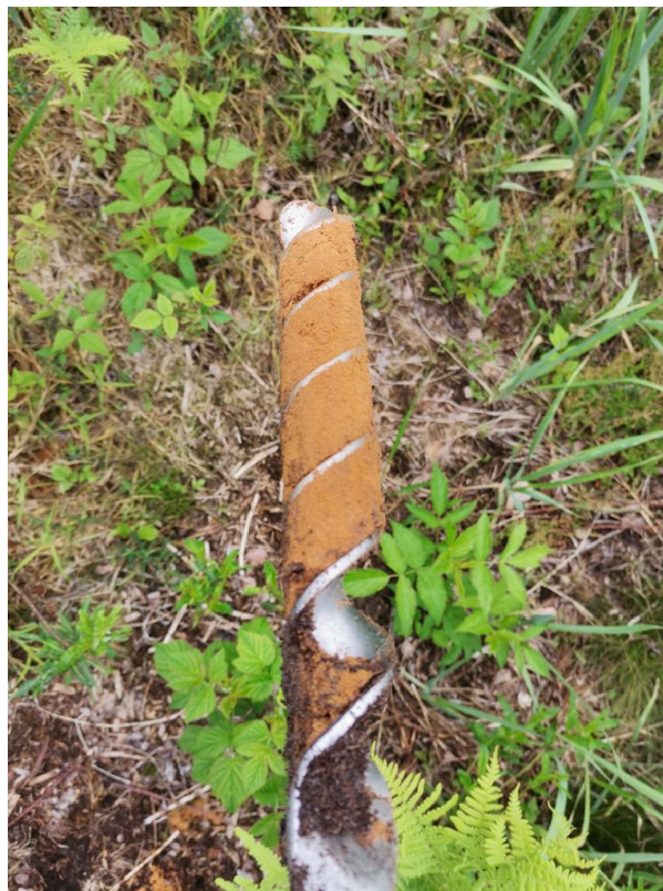
Foto 3. Sondeerimisel kasutatud metallist käsipuur.
